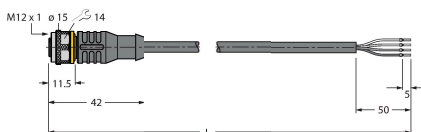
Dibujo acotado Tipo RKC4.4T-2/TEL N.º de ID 6625013
