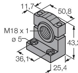
soporte de montaje, PBT negro, para sensores con rosca de 18mm, orientable
