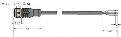
Cable de conexión, conector hembra M12, recto, 4 polos, longitud de cable: 2m, material de la funda: PVC, negro; homologación cULus; disponibles otras longitudes de cable y variantes, véase [www.turck.com](http://www.turck.com)
