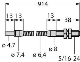
fibra óptica de vidrio, modo de detección: modo opuesto, manguito roscado (latón), diámetro del haz: 3,2 mm, revestimiento flexible de acero inoxidable, temperaturas ambiente de -140...+250 °C
