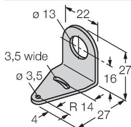
Escuadra de montaje; material VA 1.4401, para el modelo constructivo QS12 & M12
