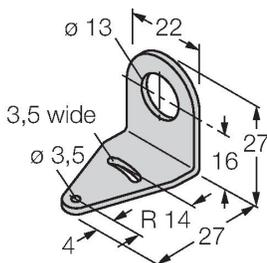
Escuadra de montaje; material VA 1.4401, para el modelo constructivo QS12 & M12
