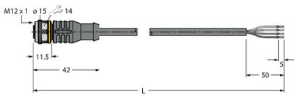
Cable de conexión, conector hembra M12, recto, de 4 polos, longitud del cable: 2 m; material de revestimiento: PVC, negro; aprobación cULus
