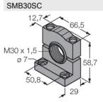
Soporte de montaje, PBT negro, para sensores con rosca de 30mm,
