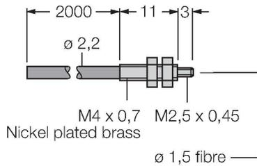
fibra óptica de material sintético, modo de detección: barrera óptica, casquillo roscado M3 x 0,5, conductor confeccionable sin pieza terminal, funda exterior de polietileno, temperatura ambiente de -30 °C...+70 °C
