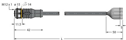
Cable de conexión, conector hembra M12, recto, de 8 polos, longitud del cable: 2 m; material de revestimiento: PVC, negro; aprobación cULus
