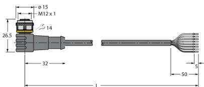
Cable de conexión, conector hembra M12, acodado, de 8 polos, longitud del cable: 2 m; material de revestimiento: PVC, negro; aprobación cULus
