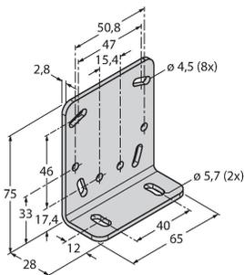
Soporte de montaje, en ángulo recto, acero inoxidable, para montaje lateral para sensores de la serie LE250/550
