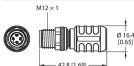
Resistencia de terminación para interruptor de seguridad RFID
