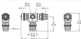
Caja de empalmes bidireccional para interruptores de seguridad RFID a fin de conectar interruptores de restablecimiento
