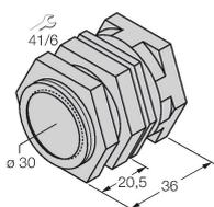
Abrazadera de montaje rápido con tope, material: Latón cromado. Rosca macho M36 × 1.5. Nota: La distancia de conmutación de los interruptores de proximidad puede variar por el uso de soportes de montaje rápido.
