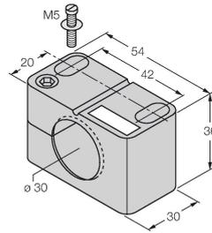
Abrazadera de montaje para sensores de tubo roscado, con tope fijo; material: PA6
