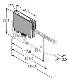
4 entradas digitales conforme a la norma EN 60947-5-6. Para sensores NAMUR, contactos sin tensión o sensores DC aprox+ de dos hilos.
