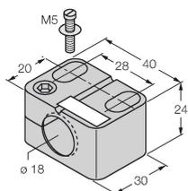
Abrazadera de montaje para sensores de tubo roscado, con tope fijo; material: PA6
