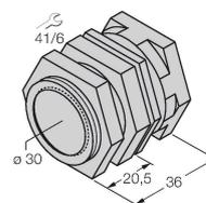
Abrazadera de montaje rápido con tope, material: Latón cromado. Rosca macho M36 × 1.5. Nota: La distancia de conmutación de los interruptores de proximidad puede variar por el uso de soportes de montaje rápido.
