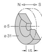
Imán de activación; Ø 31 mm (Ø 5 mm), h: 15 mm; 90 mm de distancia de conmutación alcanzable en sensores de campo magnético BIM-(E)M12 o 78 mm en sensores de campo magnético BIM-EG08; para sensores de posición lineal Q25L: distancia recomendada entre el sensor y el imán: 3...5 mm
