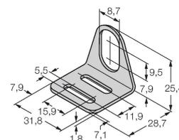
Soporte de montaje para sensores de tubo roscado; material: acero inoxidable A2 1.4301 AISI 304)
