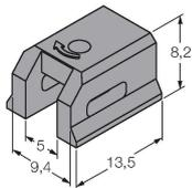
Soporte de montaje para el montaje de sensores de campo magnéticos en cilindros de ranura en cola de milano; ancho de la ranura: 9,4 mm; material: PPS
