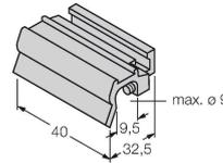
Accesorios para el montaje del sensor BIM-INT y BIM-UNT en cilindros de tirantes; diámetro del cilindro: 50...63 mm; material: aluminio; abrazaderas adicionales para diferentes diámetros del cilindro por pedido
