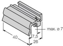
Accesorios para el montaje de los sensores BIM-INT y BIM-UNT en cilindros de tirantes; diámetro del cilindro: 32...40 mm; material: aluminio; abrazaderas adicionales para diferentes diámetros del cilindro por pedido
