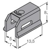
Soporte de montaje para el montaje de sensores de campo magnéticos en cilindros de ranura en cola de milano; ancho de la ranura: 7 mm; material: PPS
