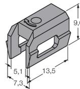
Soporte de montaje para el montaje de sensores de campo magnéticos en cilindros de ranura en cola de milano; ancho de la ranura: 7,35 mm; material: PPS
