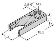
accesorios para asegurar el punto de conmutación en cilindros de ranura en T; fijación rápida en la ranura de alojamiento del sensor BIM-UNT; material: plástico
