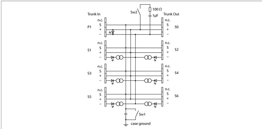
El módulo de distribución para zonas Ex de seis canales, tipo JBBS-48SC-T615B/EX, está diseñado para el PROFIBUS-PA.
