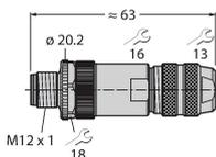
Conector macho confeccionable, M12 x 1, recto, 8 polos, conexión de brida roscada, apertura de paso de los cables 6,0 a 8,0 mm, sección transversal del conductor / capacidad de sujeción 0,14 a 0,50 mm<sup>2</sup>, carcasa de metal, tuerca acoplada en metal, admite blindaje, también para Ethernet, etc.
