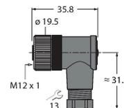
Conector hembra confeccionable, M12 x 1, acodado, 4 polos, conexión de brida roscada, apertura de paso de los cables 4,0 a 6,0 mm, sección transversal del conductor / capacidad de sujeción 0,14 a 0,75 mm<sup>2</sup>, carcasa plástica, tuerca acoplada en plástico
