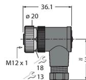
Conector hembra confeccionable, M12 x 1, acodado, 4 polos, conexión de brida roscada, apertura de paso de los cables 4,0 a 6,0 mm, sección transversal del conductor / capacidad de sujeción 0,25 a 0,75 mm<sup>2</sup>, carcasa plástica, tuerca acoplada en metal
