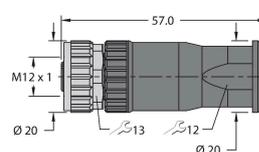
El conector hembra cableable a campo M12 x 1, recto, de 4 clavijas, conexión de terminal de tornillo, interconexión con cable de 4.0 a 8.0 mm, capacidad de terminal/ sección transversal de núcleo de 0,25 a 1,5 mm<sup>2</sup>, carcasa de plástico, tuerca metálica
