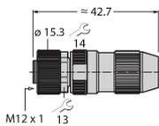
Conector hembra confeccionable, M12 x 1, recto, 4 polos, conexión de bornes de corte, apertura de paso de los cables 4,0 a 5,1 mm, sección transversal del conductor / capacidad de sujeción 0,14 a 0,34 mm<sup>2</sup>, carcasa plástica, tuerca acoplada en metal
