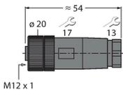
Conector hembra confeccionable, M12 x 1, recto, 4 polos, conexión de brida roscada, apertura de paso de los cables 4,0 a 6,0 mm, sección transversal del conductor / capacidad de sujeción 0,14 a 0,75 mm<sup>2</sup>, carcasa plástica, tuerca acoplada en plástico
