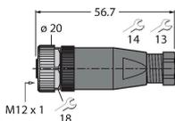
Conector hembra confeccionable, M12 x 1, recto, 4 polos, conexión de brida roscada, apertura de paso de los cables 4,0 a 6,0 mm, sección transversal del conductor / capacidad de sujeción 0,25 a 0,75 mm<sup>2</sup>, carcasa plástica, tuerca acoplada en metal
