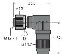
Conector hembra confeccionable, M12 x 1, acodado, 4 polos, conexión de bornes de corte, apertura de paso de los cables 4,0 a 5,1 mm, sección transversal del conductor / capacidad de sujeción 0,14 a 0,34 mm<sup>2</sup>, carcasa plástica, tuerca acoplada en metal
