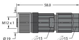
Conector hembra cableable en terreno, M12 x 1, recto, 4 polos, conexión a presión, pasacables de 4,0 a 8,0 mm, sección transversal principal/capacidad del terminal de 0,14 a 0,75 mm<sup>2</sup>, carcasa de plástico, tuerca de acoplamiento de metal
