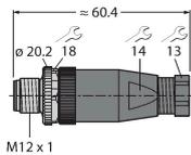
Conector macho cableable en terreno, M12 × 1, recto, 5 patillas, conexión terminal roscada, pasacables 4,0 a 6,0 mm, sección transversal principal/capacidad del terminal 0,14 hasta 0,75 mm<sup>2</sup>, carcasa de plástico, tornillo de retención de metal
