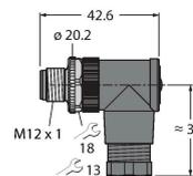
Conector macho cableable en terreno, M12 × 1, acodada, 5 patillas, conexión terminal roscada, pasacables 4,0 a 6,0 mm, sección transversal principal/capacidad del terminal 0,14 hasta 0,75 mm<sup>2</sup>, carcasa de plástico, tornillo de retención de metal
