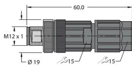
Conector macho cableable en terreno, M12 × 1, recto, 5 patillas, conexión a presión, pasacables de 4,0 a 8,0 mm, sección transversal principal/capacidad del terminal de 0,14 a 0,75 mm<sup>2</sup>, carcasa de plástico, tornillo de retención de metal
