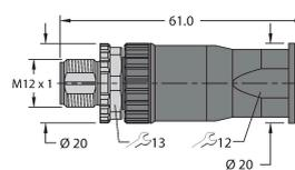
Conector macho cableable en terreno, M12 × 1, recto, 5 patillas, conexión terminal roscada, pasacables 4,0 a 8,0 mm, sección transversal principal/capacidad del terminal 0,25 hasta 1,5 mm<sup>2</sup>, carcasa de plástico, tornillo de retención de metal
