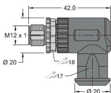
Conector macho cableable en terreno, M12 × 1, acodada, 5 patillas, conexión terminal roscada, pasacables 4,0 a 8,0 mm, sección transversal principal/capacidad del terminal 0,25 hasta 1,5 mm<sup>2</sup>, carcasa de plástico, tornillo de retención de metal
