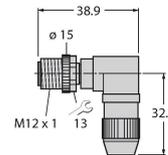
Conector macho confeccionable, M12 x 1, acodado, 4 polos, conexión de bornes de corte, apertura de paso de los cables 4,0 a 5,1 mm, sección transversal del conductor / capacidad de sujeción 0,14 a 0,34 mm<sup>2</sup>, carcasa plástica, tuerca acoplada en metal
