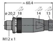
Conector macho cableable en terreno, M12 x 1, recto, 4 patillas, conexión terminal roscada, pasacables 4,0 a 6,0 mm, sección transversal principal/capacidad del terminal 0,14 hasta 0,75 mm<sup>2</sup>, carcasa de plástico, tornillo de retención de metal
