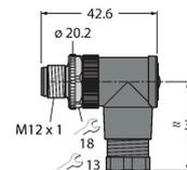
Conector cableable en terreno, M12 x 1, acodado, 4 polos, conexión terminal roscada, pasacables 4,0 a 6,0 mm, sección transversal principal/capacidad del terminal 0,14 hasta 0,75 mm<sup>2</sup>, carcasa de plástico, tornillo de retención de metal
