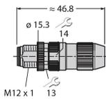
Conector macho confeccionable, M12 x 1, recto, 4 polos, conexión de bornes de corte, apertura de paso de los cables 4,0 a 5,1 mm, sección transversal del conductor / capacidad de sujeción 0,14 a 0,34 mm<sup>2</sup>, carcasa plástica, tuerca acoplada en metal
