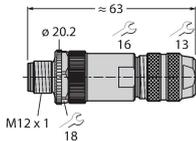
Conector macho confeccionable, M12 x 1, recto, 8 polos, conexión de brida roscada, apertura de paso de los cables 6,0 a 8,0 mm, sección transversal del conductor / capacidad de sujeción 0,14 a 0,50 mm<sup>2</sup>, carcasa de metal, tuerca acoplada en metal, admite blindaje, también para Ethernet, etc.
