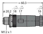
Conector macho cableable en terreno, M12 × 1, recto, 8 patillas, conexión terminal roscada, pasacables de 6,0 a 8,0 mm, sección transversal principal/capacidad del terminal de 0,14 a 0,50 mm<sup>2</sup>, carcasa de plástico, tornillo de retención de metal
