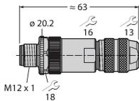
Conector macho confeccionable, M12 × 1, recto, 8 polos, conexión de brida roscada, apertura de paso de los cables 6,0 a 8,0 mm, sección transversal del conductor / capacidad de sujeción 0,14 a 0,50 mm<sup>2</sup>, carcasa de metal, tuerca acoplada en metal, admite blindaje, también para Ethernet, etc.
