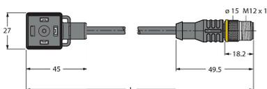
Cable de extensión, conector de válvula, tipo A a conector macho M12, recto, de 5 polos, longitud del cable: 0.6 m; material de revestimiento: PUR, negro
