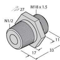
Adaptador enrosicable para sensores de flujo de la serie F(T)CST para enroscar una pieza en T o un manguito de soldadura; conexión del proceso de rosca externa NTP de 1/2"
