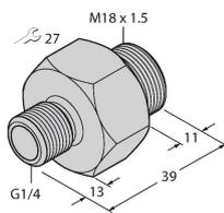
Adaptador enrosicable para sensores de flujo de la serie F(T)CST para enroscar una pieza en T o un manguito de soldadura; conexión del proceso de rosca externa de G1/4"
