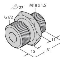
Adaptador enrosicable para sensores de flujo de la serie F(T)CST para enroscar una pieza en T o un manguito de soldadura; conexión del proceso de rosca externa de G1/2"
