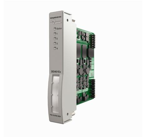
El módulo de salida DO401Ex sirve para conectar actuadores con seguridad intrínseca tales como válvulas o elementos de indicación.
