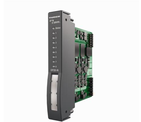
El módulo de entrada DF20-N está equipado con ocho canales según NAMUR que están agrupados en dos bloques. Por cada bloque hay una entrada de frecuencia y tres salidas/entradas de control.
