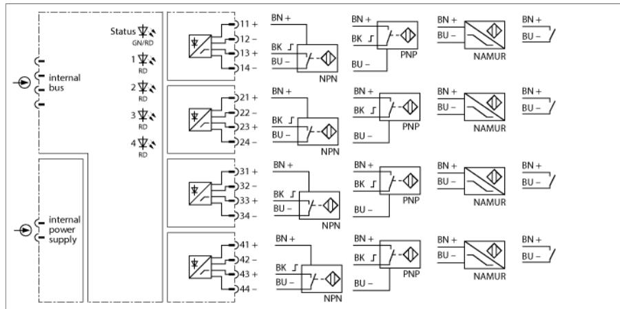
El módulo de entrada DI40-N sirve para la conexión de sensores según NAMUR (DIN EN 60947-5-6), sensores de hilos (NPN, PNP) o contactos mecánicos.
