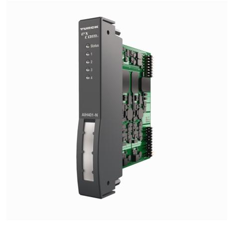
El módulo de entrada AIH41-N sirve para conectar transductores de cuatro conductores (entrada pasiva = no alimentando / transmisor activo).
