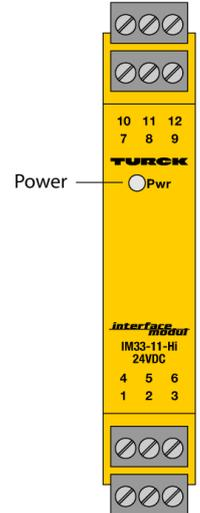
A través del transductor aislador de 1 canal HART®IM33-11-HI/24VCC se operan transductores HART®de 2 hilos (III) y se envía la señal de medición separada galvánicamente. Además de las señales analógicas, también las señales digitales de la comunicación HART®pueden transmitirse.
