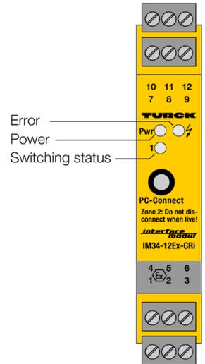
El amplificador de medición de temperatura Ex de 1 canal del tipo IM34-12EX-CRI procesa los cambios dependientes de la temperatura de resistencias Ni100/Pt100 y termoelementos de los tipos B, E, J, K, L, N, R, S y T, así como tensiones bajas en el rango de -160...+160 mV, emitiéndolos como señales de corriente de 0/4...20 mA lineares a la temperatura.
