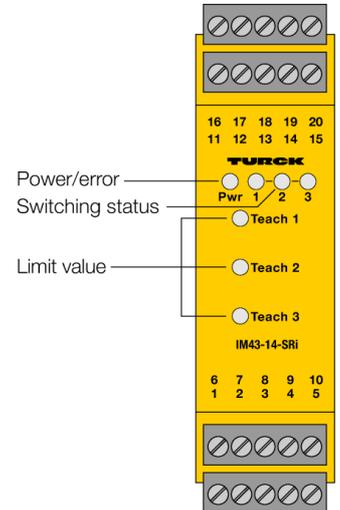
El transmisor de señales de valor límite IM43-14-SRI de un canal controla alternativamente las corrientes de medición de 0/4...20 mA o bien las tensiones de medición de 0/2...10 V frente a los límites máximo y mínimo especificados.
