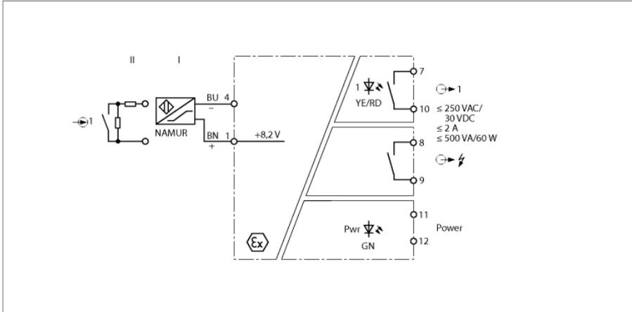
El amplificador separador de un canal de tipo IM1-121EX-R está dotado de un circuito de entrada con seguridad intrínseca.
