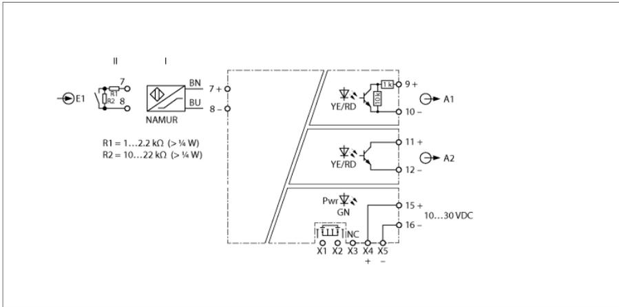
En el repetidor NAMUR IM12-DI03-1S-1NAM1T-PR/24 VCC se puede conectar sensores conforme a la norma EN 60947-5-6 (NAMUR) o contactos sin potencial. Esto puede instalarse dentro de la zona 2. El circuito de salida también está equipado con una salida de transistor. El dispositivo se puede alimentar desde un puente de alimentación que también transmite una señal de falla colectiva. El dispositivo cumple los requisitos de la norma NE21.
