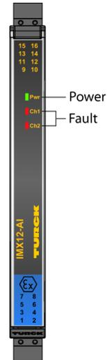
A través del transductor aislador HART® de 2 canales IMX12-AI01-2I-2IU-H0/24VCC operan transductores de 2 hilos HART® con seguridad intrínseca en la zona Ex y se envían las señales de medición a la zona no Ex. Además de las señales analógicas se puede efectuar también la transmisión bidireccional de las señales digitales de la comunicación HART®. Asimismo se pueden utilizar transmisores HART® de 2 hilos activos y pasivos.
