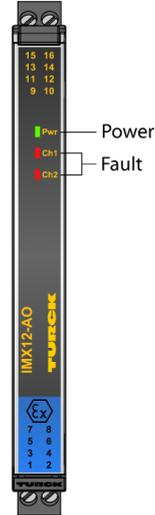
El separador de señal de 2 canal IMX12-AO01-2I-2I-H0/24VCC transmite la señal de corriente normalizada, y aislada galvánicamente en una relación 1:1 desde la zona no Ex a la zona Ex. Además de la señal analógica se puede efectuar también la transmisión bidireccional de las señales digitales de la comunicación HART®. Aplicaciones típicas son la activación de convertidores I/P o en equipos de indicación en zonas Ex.
