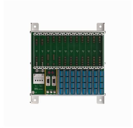
El portamódulos MT08-3G se compone de una placa de circuito posterior (backplane) y del sistema portante propiamente dicho. Sirve para alojar un Gateway, dos fuentes de alimentación, así como 8 módulos E/S. De este modo pueden conectarse al portamódulos hasta 64 entradas/salidas binarias o bien 32 salidas/entradas analógicas o bien cada forma híbrida.
