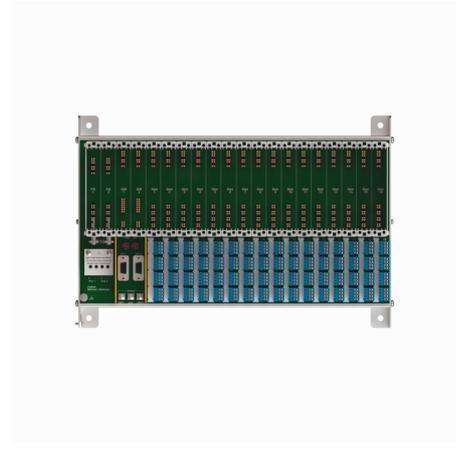
El portamódulos MT16-3G se compone de una placa de circuito posterior (backplane) y del sistema portante propiamente dicho. Sirve para alojar dos Gateways, dos fuentes de alimentación, así como 16 módulos E/S. De este modo pueden conectarse al portamódulos hasta 128 entradas/salidas binarias o bien 64 salidas/entradas analógicas o bien cada forma híbrida.
