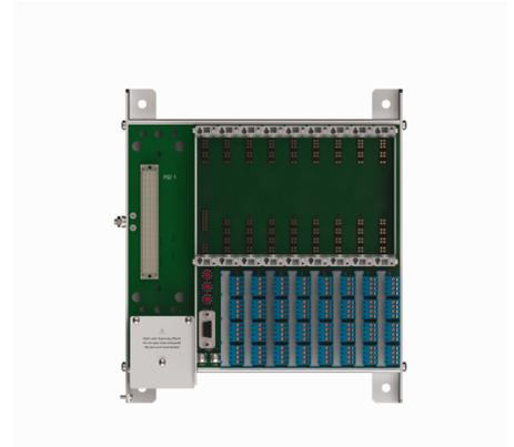
El portamódulos MT08-2G se compone de una placa de circuito posterior (backplane) y del sistema portante propiamente dicho. Sirve para alojar un Gateway, dos fuentes de alimentación, así como 8 módulos E/S. De este modo pueden conectarse al portamódulos hasta 64 entradas/salidas binarias o bien 32 salidas/entradas analógicas o bien cada forma híbrida. A diferencia que con el MT16, en el MT08 no pueden definirse ni gateways ni fuentes de alimentación de manera redundante.
