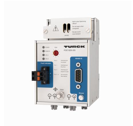
Le convertisseur de médias à fibre optique FOC12... convertit les signaux RS485-IS, par exemple émis par un dispositif PROFIBUS-DP ou Modbus RTU, des lignes en cuivre vers les lignes en fibre optique, et vice versa. Les signaux de bus de sécurité intrinsèque peuvent ainsi être transmis depuis la zone 1, libres de potentiel et sans parasites, sur de grandes distances.
