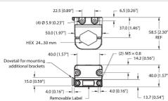
Équerre de montage ; largeur de clé variable 24 - 30 mm ; étiquette amovible 20 × 9 mm
