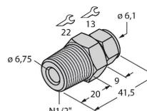
Raccordement par bague de serrage pour le montage direct de sondes de température ; diamètre sonde 6 mm ; raccordement au processus filetage extérieur 1/2" NPT
