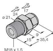
Raccordement par bague de serrage pour le montage direct de sondes de température ; diamètre sonde 6 mm ; raccordement au processus filetage extérieur M18×1
