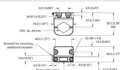
Équerre de montage ; largeur de clé variable 24 - 30 mm ; étiquette amovible 20 × 9 mm
