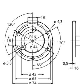
accouplement stator en acier inoxydable pour codeur à arbre creux, diamètre primitif de référence 65 mm, pour les applications à jeu axial et radial avec dynamique élevée
