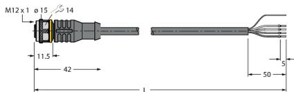
Câble de bus pour CAN (DeviceNet, - CANopen), connecteur femelle M12, droit, longueur de câble : 5 m, matériau de la gaine : PUR, anthracite ; homologation cULus
