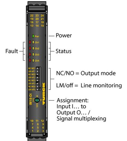
Les amplificateurs séparateurs IM18-DI03... transmettent des signaux binaires séparés galvaniquement. Des détecteurs suivant EN 60947-5-6 (NAMUR) ou des contacteurs libres de potentiel peuvent être raccordés à l'appareil. Les appareils sont aussi adaptés à un fonctionnement en zone 2.
