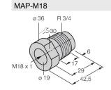
adaptateur de montage; matériau: polypropylène; possibilité de remplacement du détecteur dans des cuves remplies (l'adaptateur reste dans la cuve lors du remplacement)
